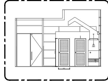
기존 갤러리 DOOR : 840x2100 실내기 사이즈 1,100x1800으로 갤러리 DOOR 사이즈 변경 필요
